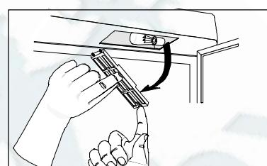
Сожмите пружинку двумя пальцами и одновременно вытяните защитную решётку лампочки по направлению вниз. Замените перегоревшую лампочку на аналогичную фирменную лампочку, цоколь E14, мощность не более 25 Вт. Диаметр стекла лампочки у цоколя должно составлять не менее 18 мм, для того чтобы она плотно прилегала к уплотнительной прокладке.
