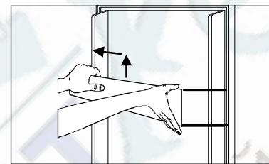
Ящик для хранения овощей разделён на несколько отделений для хранения различных видов овощей. Полки и дверные отделения легко снимаются, их можно менять местами. Некоторые полки следует сначала приподнять с задней части, для того чтобы их можно было вытянуть на себя.
